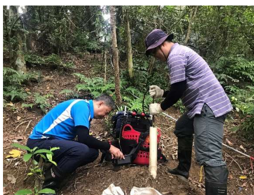
圖2、傾斜管量測情形
