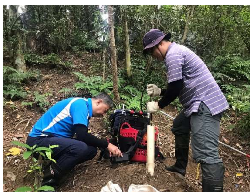
圖2、傾斜管量測情形
