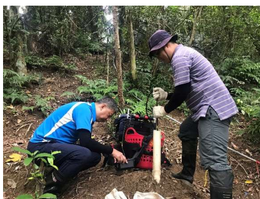
圖2、傾斜管量測情形
